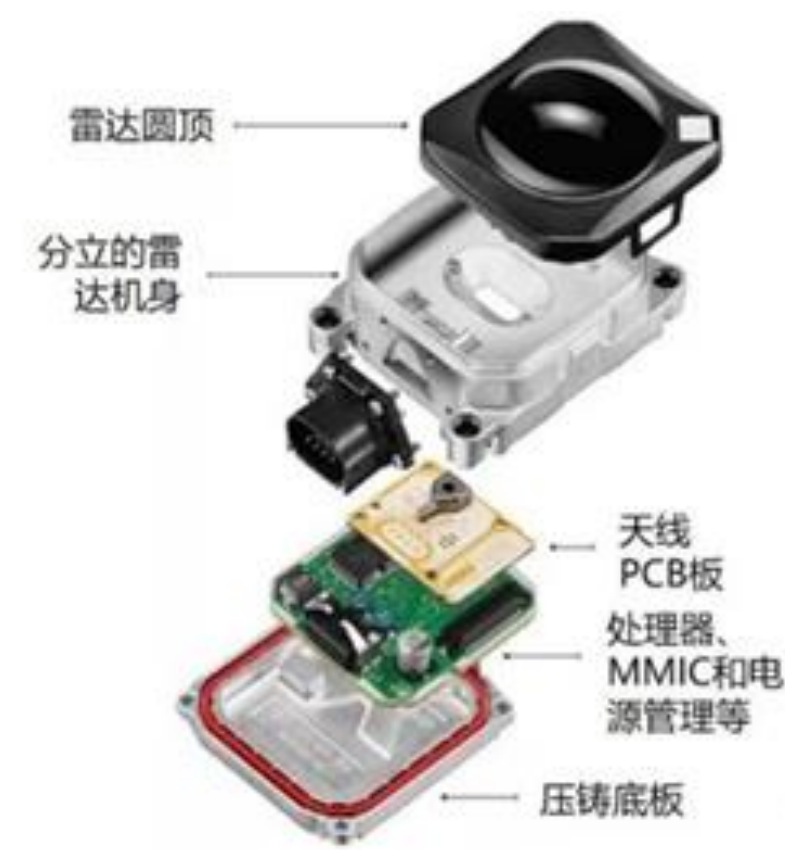
图：博世第三代毫米波雷达构成
