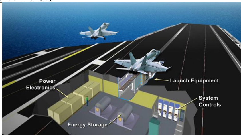
图26. 舰载战斗机电磁弹射装置示意图
