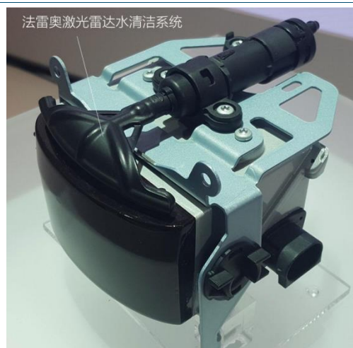
图表13: 法雷奥激光雷达清洗装置
