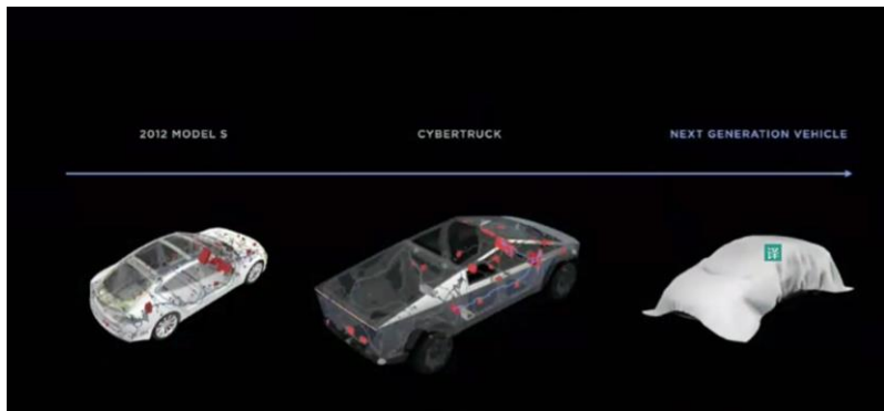
图5：12V转变为48V，适应更多高功率需求功能
