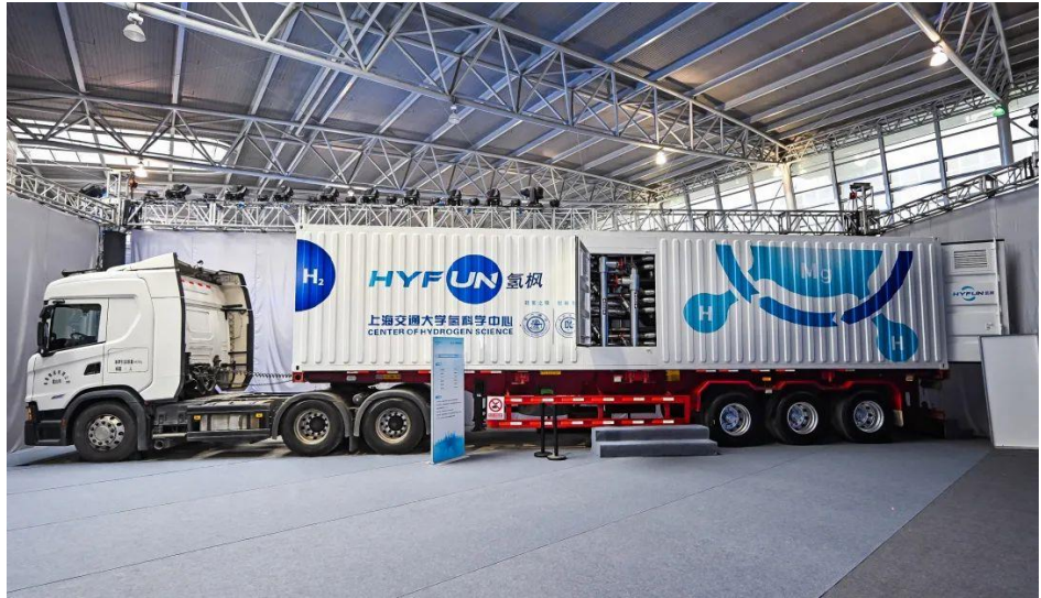
图 9 全国首台吨级镁基固态储运氢车
