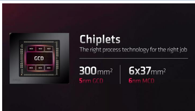
图表275： AMD Radeon 7000 系列使用 Chiplet 技术
