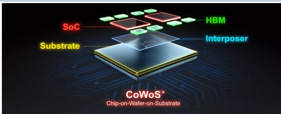
图表354：台积电 CoWoS 封装示意图
